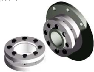
Abb.2: Kraftschluss außerhalb der Welle-Nabe-Verbindung
